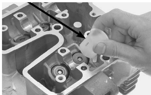
JUNTA/ANEL DE VEDAÇÃO PROTECTOR DA CAVIDADE
